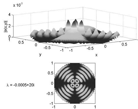
(d) Eigenfunction corresponding to lightly damped eigenvalue  $\lambda = -0.0005 + i 20$ .
