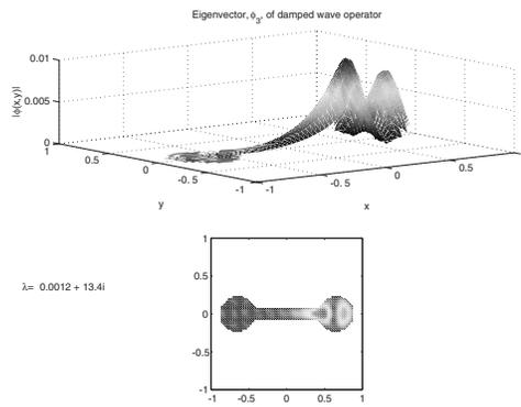
(d) Eigenfunction corresponding to lightly damped eigenvalue  $\lambda = -0.0012 + i 13.4$ .
